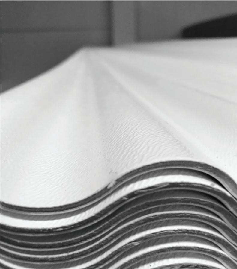
PESO LIGERO 6 KG/M<sup>2</sup>, AISLAMIENTO ACÚSTICO Y TÉRMICO 40%, 100 KG DE CARGA PUNTUAL CON CARRIOLAS ENTRE 60 - 90 CM DE DISTANCIA, PROBADA CON FUEGO, AGUA, HUMEDAD Y CORROSIÓN, CERTIFICADA POR ISO9001 E ISO14001.
