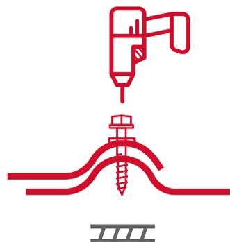
3. UNA VEZ INSTALADO EL TORNILLO, CUBRA LA CABEZA DEL MISMO CON LA TAPA PLÁSTICA DECORATIVA PROVISTA PARA TAL FIN. SE RECOMIENDA AJUSTAR LOS TORNILLOS ANTES DE FINALIZAR LA INSTALACIÓN. LOS TORNILLOS NO DEBEN QUEDAR NI MUY APRETADO NI MUY FLOJO.
