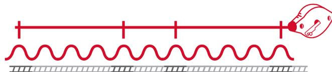
2. PERFORE CON EL TALADRO A TRAVÉS DEL ORIFICIO DEL CAUCHO SELLADOR, HASTA QUE VAYA PENETRANDO COMPLETAMENTE LAS 2 CUBIERTAS Y LA CARRIOLA. EL DIÁMETRO DE LOS AGUJEROS DE PERFORACIÓN DEBE SER 2 MM MÁS GRANDE QUE EL DE LOS TORNILLOS.
